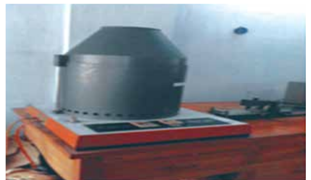
কালার ফাস্টনেস টেস্টার এ যন্ত্র দ্বারা পাটের তৈরী রঞ্জিন কার্পেট, চট বা ইয়ার্নের রং এর স্থায়ীত্ব নিরূপণ করা হয়।
